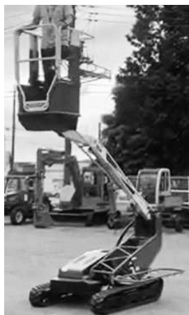
図1 ブーム式高所作業車 人が乗車する場所は周囲が囲まれたゴンドラ
