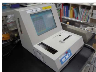
エンドトキシン・ \beta Dゲルカン測定システム トキシメーター MT-358
