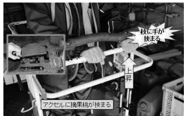
図3. 摘果した桃が足下のアクセセルと床の間にはさまり，足を離してもゴンドラが上昇を続け，枝と手すりの間に手が挟まれた。
